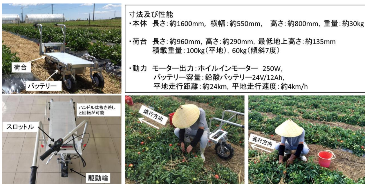
図1 開発した加工用トマト収穫電動台車（OYT-01）、台車使用収穫、慣行収穫の様子
