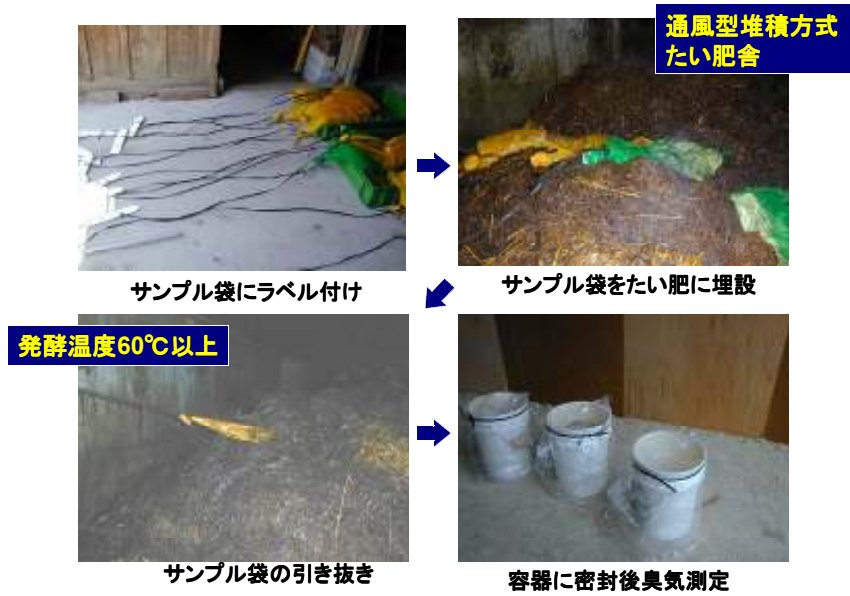
図1 たい肥化バック法による臭気測定の流れ
